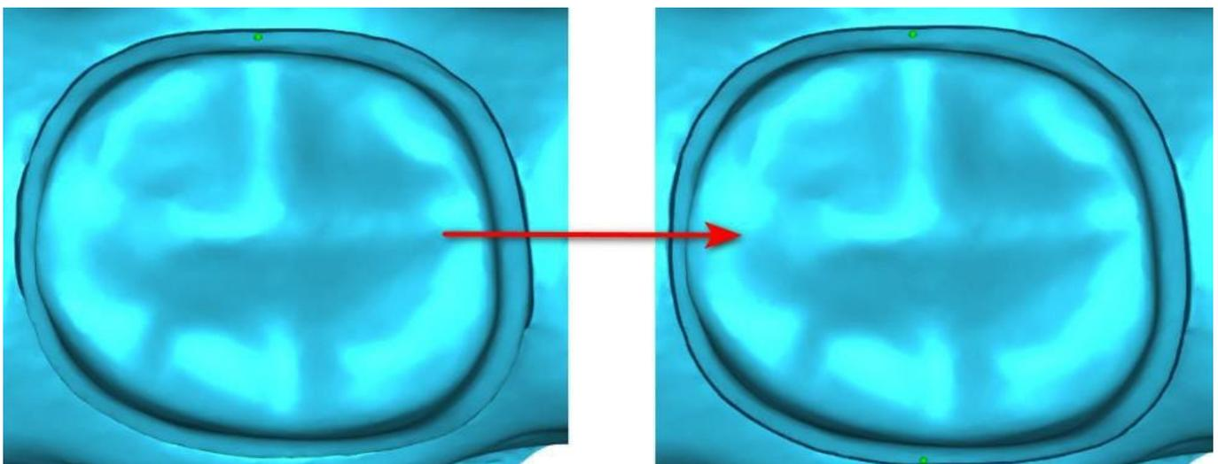
Um mit der manuellen Randlinie zu arbeiten, klicken Sie auf das Auswahlfeld „Manueller Modus“. Klicken Sie auf die Punkte (Umschalttaste + Linksklick) entlang der restlichen Zahnstruktur. Die geschlossene Kurve kann mit gedrückter Umschalttaste und linker Maustaste verändert werden.
