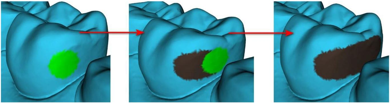
Der Approximalbereich kann durch Auswahl von „Bereich löschen" gelöscht werden. Durch Drücken der Shift-Taste und Halten der linken Maustaste wird der interproximale Bereich definiert und eine braune Kontur um die Auswahl, die die Kronen- und Brückenbasis darstellt, erzeugt. Durch Drücken der Strg-Taste und Linksklick mit der Maus kann die Auswahl entfernt werden.
