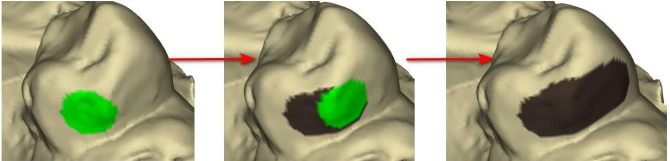
Der interproximale Bereich kann durch Auswahl von „Bereich löschen“ gelöscht werden. Durch Drücken der Shift-Taste und Halten der linken Maustaste wird der interproximale Bereich definiert und eine braune Kontur um die Auswahl, die die Kronen- und Brückenbasis darstellt, erzeugt.
