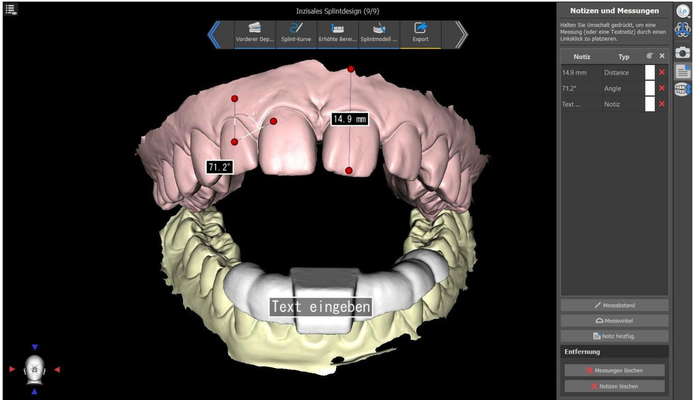
Wählen Sie die Schaltfläche **Distanz messen**, um eine 3D-Messung durchzuführen. Klicken Sie mit der linken Maustaste mit dem Mauszeiger auf das Modell, um den Startpunkt der zu messenden Strecke zu markieren und klicken Sie erneut auf das Modell, um den Endpunkt der gemessenen Strecke zu markieren. Um die Messung zu korrigieren, können Sie einen der Endpunkte anfassen und verschieben.
