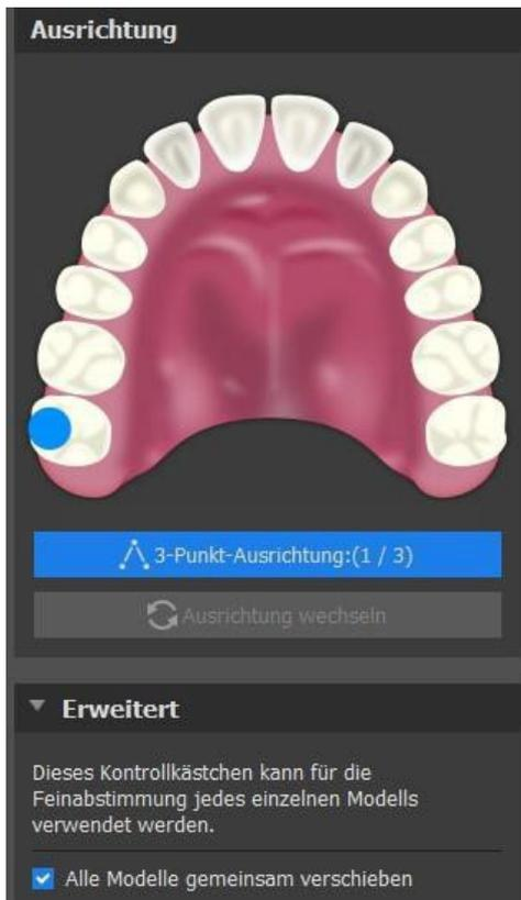
Kontrollkästchen **Alle Modelle zusammen verschieben** kann verwendet werden, wenn der Benutzer die Feinabstimmung für jedes Modell einzeln vornehmen möchte. Um die Ausrichtung des Modells zu ändern, klicken Sie auf die Schaltfläche **Ausrichtung ändern**
