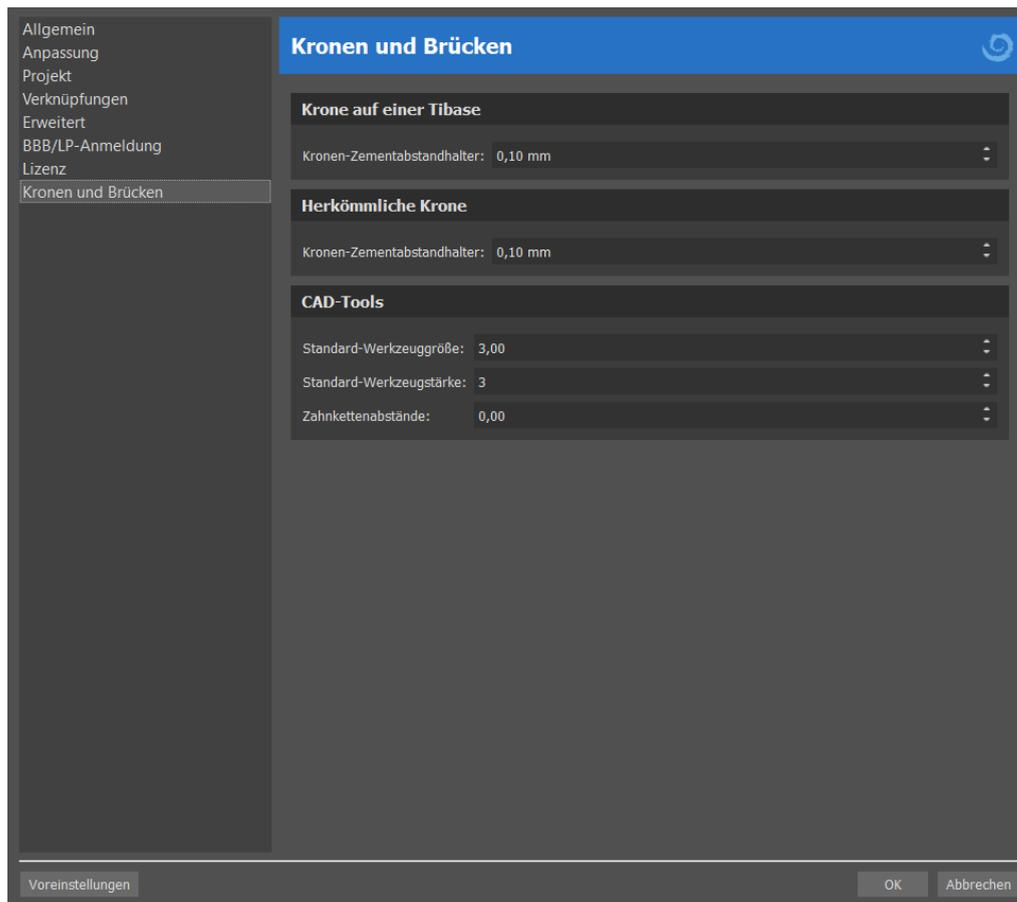
Unter „Einstellungen > Krone und Brücke“ kann der Kronen-Zementabstandshalter für verschiedene Restaurationstypen festgelegt werden, die im Panel „Restaurationsgestaltung“ verfügbar sind. CAD-Tools sind für das Prothesen-Modul verfügbar. Die „Standard-Werkzeuggröße“ wird für die Auswahl der Standard-Werkzeuggröße verwendet. Die „Standard-Werkzeugstärke“ definiert die Standard-Stärke des Werkzeugs. Mit „Zahnketten-Abstand“ kann der Abstand zwischen den Zähnen der Zahnkette festgelegt werden.
