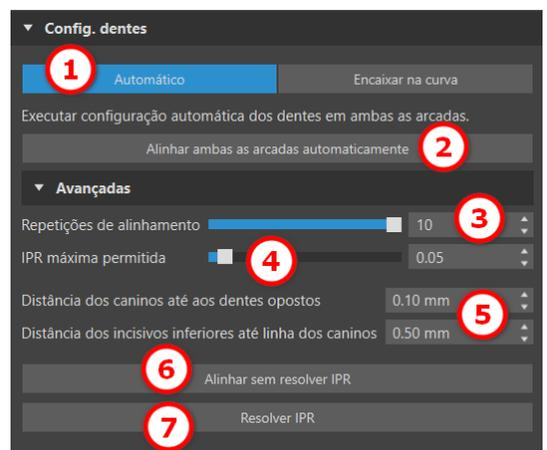
o número de execuções do algoritmo, 10 por padrão. O controle deslizante "IPR máximo permitido" (4) permite IPR até um determinado valor, já que o padrão é nenhum IPR. Parâmetros adicionais podem ser editados na seção de nivelamento para cada mandíbula (5).
