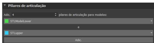
Ambos os modelos não precisam ser fechados antes de adicionar os pinos de articulação. Os modelos abertos são fechados durante esse processo automaticamente. Ambos os modelos devem estar alinhados antes de adicionar pinos.
