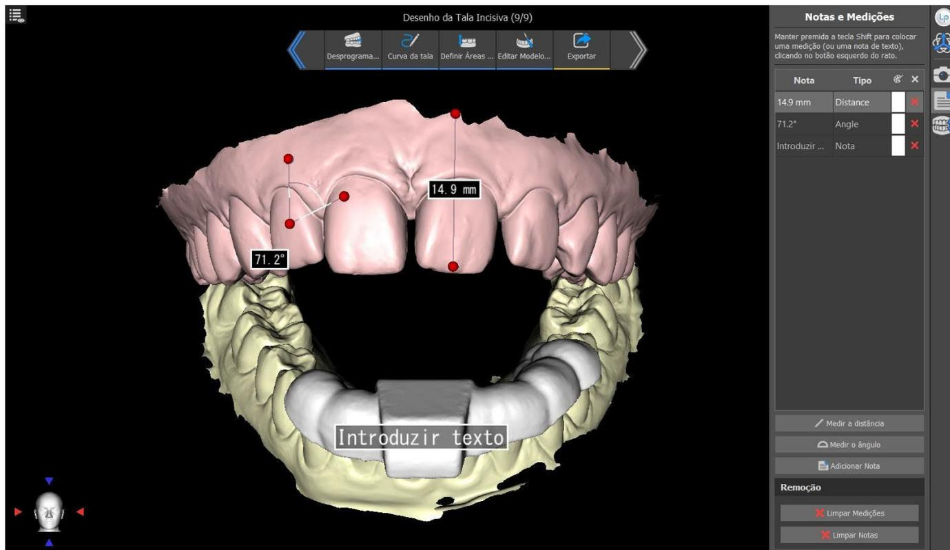
Selecione o botão **Medir distância** para fazer quaisquer medições 3D. Clique no botão esquerdo do mouse com o ponteiro no modelo para marcar o ponto inicial da distância a ser medida e clique novamente no modelo para marcar o ponto final da distância medida. Para corrigir a medida, você pode pegar um dos pontos finais e movê-los.
