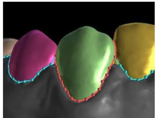
A margem gengival pode ser editada apenas para o dente ativo. O dente ativo pode ser alterado em toda a imagem da mandíbula esquemática no painel ou clicando no dente segmentado diretamente na visualização 3D.
