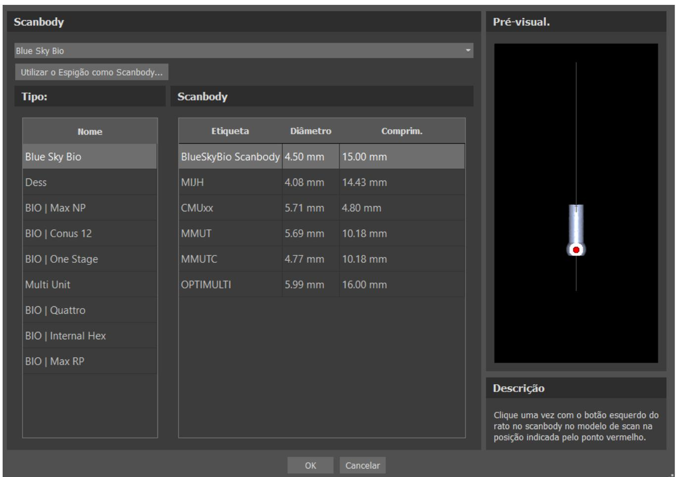
Depois de escolher um corpo de escaneamento no catálogo, ele pode ser colocado clicando na cabeça do pilar escaneado no modelo - para obter a melhor posição de ajuste, é bom clicar no local ilustrado pelo marcador vermelho, como mostra o catálogo pré-visualização do corpo da digitalização.
