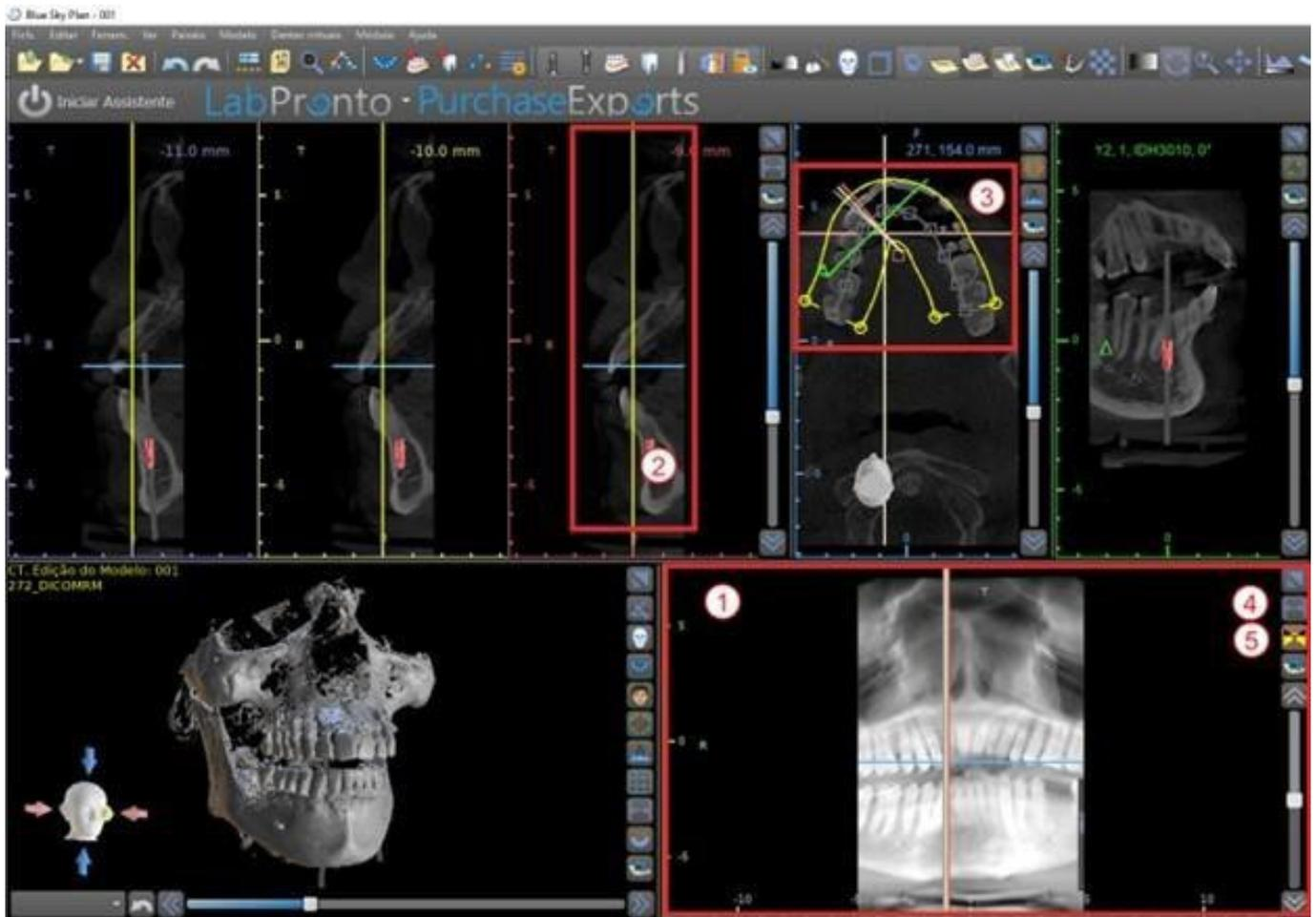
A linha indicadora da fatia panorâmica aparece nas vistas em corte transversal (2) e axial (3). À medida que o usuário percorre as imagens panorâmicas, a curva panorâmica se move ao longo do plano axial horizontal para indicar a localização da fatia específica representada pela localização da curva panorâmica.
