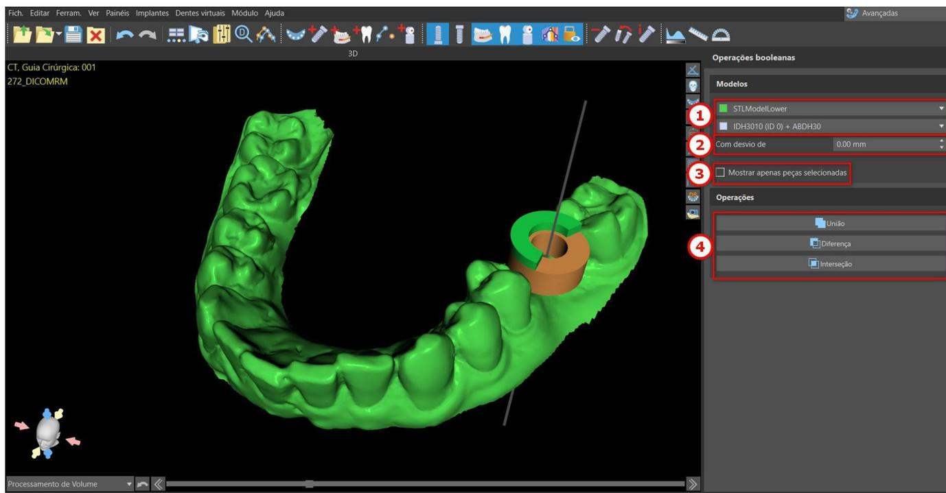
Para iniciar uma operação booleana, selecione dois modelos na seção de modelos (1) com o deslocamento preferido (2) e clique na opção de operações (4). A malha resultante da operação estará disponível no painel Superfícies.
