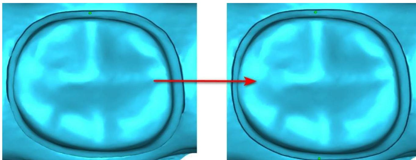
Para trabalhar com a detecção manual da linha de margem, clique no botão “Modo manual”. Clique nos pontos (Shift + botão esquerdo do mouse) ao longo da estrutura remanescente do dente. A curva fechada pode ser modificada ao segurar Shift e o botão esquerdo do mouse.
