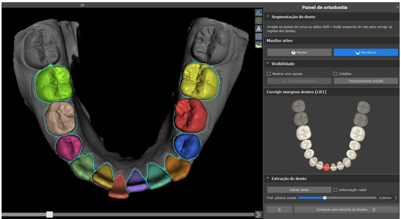
Após a segmentação automática, você pode ajustar a margem gengival detectada do dente ativo / selecionado arrastando os pontos de controle da curva ou desenhando manualmente uma parte da curva no modelo enquanto mantém pressionada a tecla “Shift” e o mouse esquerdo botão simultaneamente.
