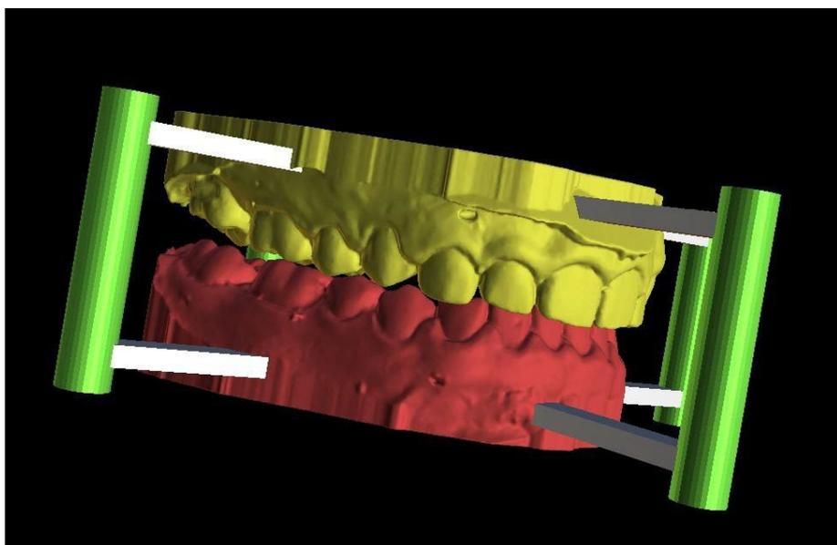
Os pinos e as ferramentas de manipulação serão exibidos. As dimensões dos braços de conexão e dos pinos podem ser alteradas arrastando os elementos de manipulação que aparecem quando o usuário passa o mouse sobre esse objeto. As setas permitem que os pinos sejam movidos para os lados e os elementos de escala alterem a espessura dos pinos.
