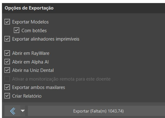
Os modelos gerados podem ser exportados do software na forma de modelos STL pressionando o botão "Exportar". Ao selecionar "Abrir no Alpha AI", "Abrir no RayWare", ou "Abrir no Uniz Dental", os modelos podem ser exportados para o respectivo software de impressão 3D externo.
